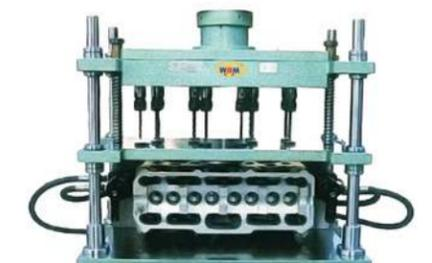
缸体加工，侧面定位，双油缸夹紧
